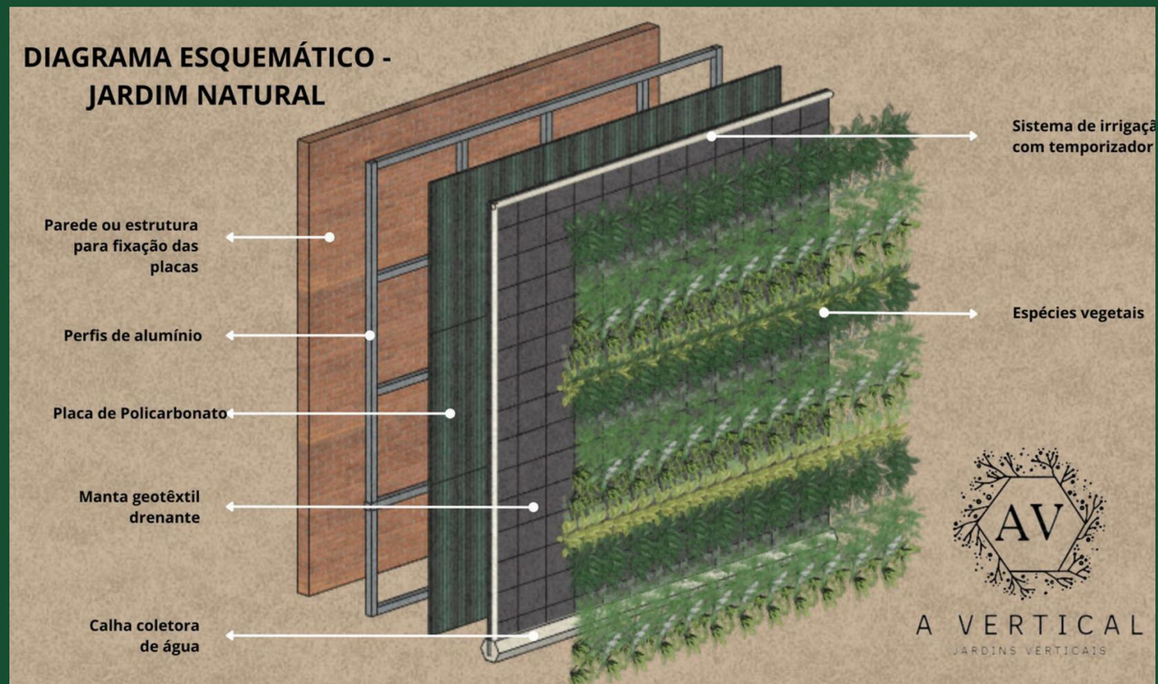
DIAGRAMA ESQUEMÁTICO DO SISTEMA DE MONTAGEM DO
